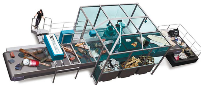
Рисунок 4. Умный робот для сортировки и сбора мусора
